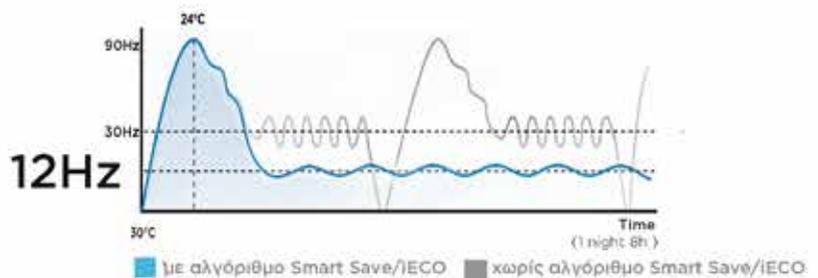
Η τεχνολογία Inverter Quattro™ επιτρέπει τη σταθερή λειτουργία του συμπιεστή στην εξαιρετικά χαμηλή ταχύτητα των **12Hz**. Χάρη στους αλγόριθμους ελέγχου του Smart Save, δίνεται η δυνατότητα σταθερής λειτουργίας του συμπιεστή με μειωμένες δονήσεις έως και **90%**.
